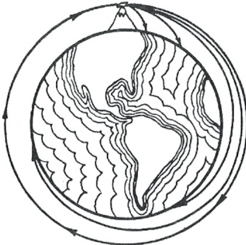
Figura 51. — Descripción newtoniana de un proyectil como un satélite. La longitud de la trayectoria crece con la velocidad inicial aplicada al proyectil, de tal modo que cada vez va más lejos alrededor de la superficie curva de la tierra. Cuando la velocidad es suficientemente grande, el proyectil no cae sobre la tierra, sino que continúa moviéndose según una órbita aproximadamente circular.
